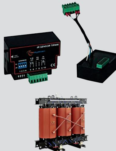
La centralina NT935IR-AD, accoppiata ai sensori infrarossi dedicati TIR409, permette di effettuare il controllo della temperatura senza contatto fisico tra la sonda e la superficie da misurare. Tale caratteristica la rende indispensabile per il monitoraggio termico di avvolgimenti in media o alta tensione, ove l'utilizzo di sensori PT100 non è consigliato o permesso a causa dei problemi di isolamento elettrico e quindi di sicurezza.
